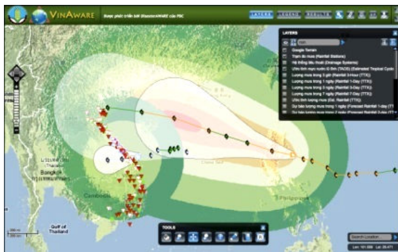
Hình 2: Hệ thống hỗ trợ ra quyết định và cảnh báo sớm -VinAWARE EWDS theo dõi cơn bão nhiệt đới Haitang (trái) và cơn bão nhiệt đới Nesat (phải) (27-11-2011) và cảnh báo những khu vực ngập, kết hợp với thông tin dự báo từ mô hình dự báo mưa TAOs.
